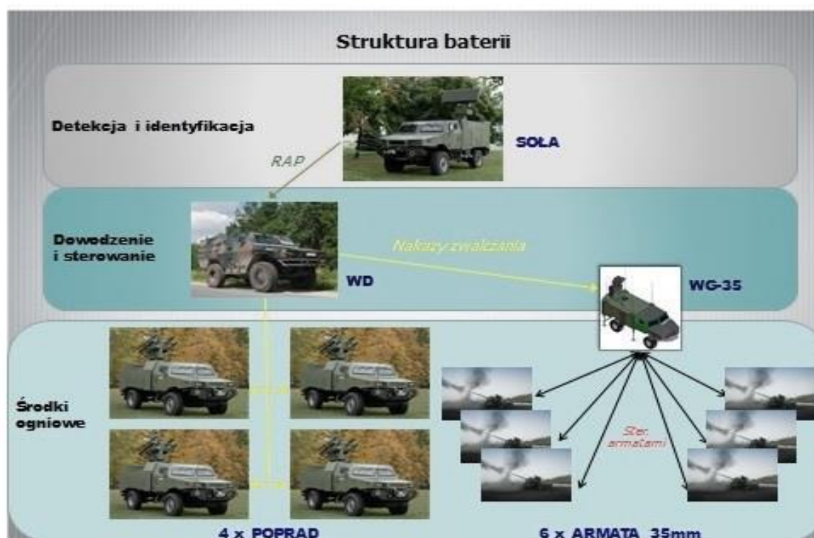
Rys. 1. Przykładowy skład baterii z zestawami rakietowymi Poprad i artyleryjskimi kalibru 35 mm Źródło: M. Dura, Zestaw przeciwlotniczy Poprad i jego miejsce w Tarczy Polski , http://www.defence24.pl/analiza_zestaw-przeciwlotniczy-poprad-i-jego-miejsce-w-tarczy-polski , (22.07.2017)
