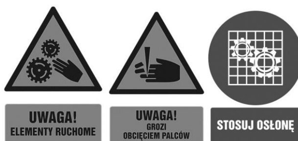
Schemat 2. Oznaczenia znakami bezpieczeństwa na stanowisku pracy spęczarki Źródło: https://znaki-bhp.pl/produkty/78_bezpieczenstwo_i_higiena_pracy ; https://znaki-bhp.pl/produkty/71_bezpieczenstwo_i_higiena_pracy (24.01.2023).
