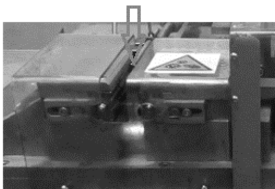
Zdjęcie 8. Wycięcie w szczękach, w którym umieszczany jest poliamid
