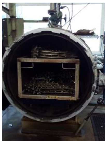
Zdjęcie 5. Autoklaw z umieszczonym wewnątrz wózkiem z formami Źródło: E. Picuch – opracowanie własne.
