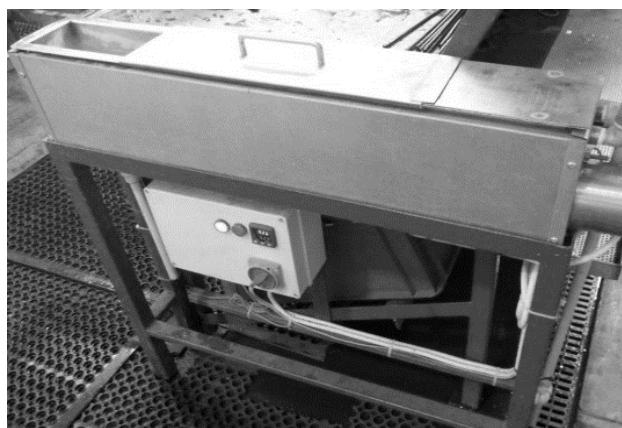
Zdjęcie 2. Wanna do podgrzewania przewodów poliamidowych Źródło: E. Picuch – opracowanie własne.
